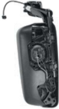
Tragarmschale unten, Adapterplatte, Spiegelkopf an Tragarm montiert:
