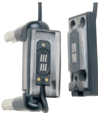
Das Direktkontaktierungssystem 271 ist in jeweils einem Kontaktelement am Haltebock und am Aufsteckkeil integriert. Durch Zusammenfügen der Schwalbenschwanzführung wird die Kontaktierung mit federnden Kontakten am Haltebock an die Kontaktflächen im Aufsteckkeil übertragen.
